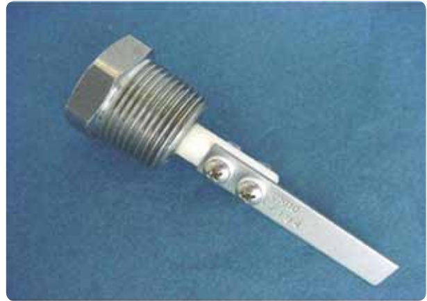
Kupon til korrosionsovervågning
