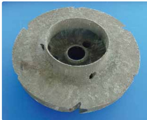
Pumpehjul udsat for syrekorrosion
