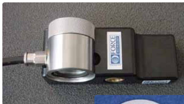
Tint-Tester til kontrol af baggaskvalitet med eksempel på testskive
